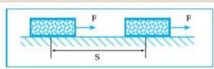
Gambar di atas melukiskan suatu gaya  $F$  bekerja pada sebuah benda yang terletak pada bidang datar, sehingga benda berpindah sejauh  $s$  searah dengan arah gaya  $F$ . Selama perpindahan benda tersebut dikatakan gaya  $F$  telah melakukan suatu usaha pada benda yang besarnya dapat dinyatakan dengan persamaan:
