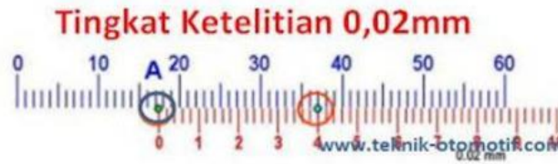
Gambar 12. Skala metris tingkat ketelitian 0,02 mm
