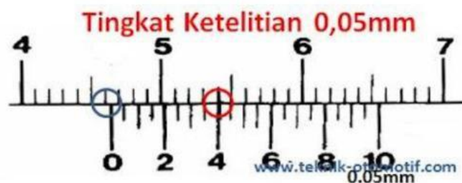
Gambar 11. Skala metris tingkat ketelitian 0,05 mm
