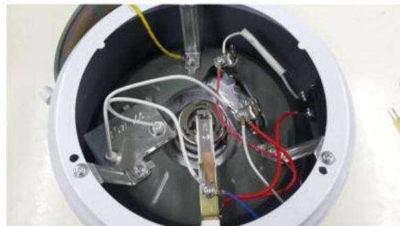
รูปที่ 5.3 แสดงวงจรและส่วนประกอบภายในของหม้อหุงข้าวไฟฟ้า
