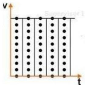
Susunlah potongan pita dari langkah 11 berderet ke kanan seperti gambar di bawah untuk kereta dinamika dengan kecepatan rendah v1!
