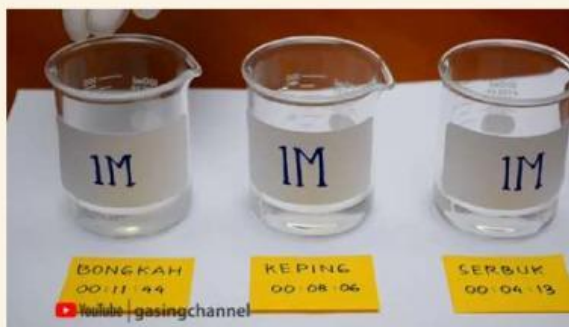
Gambar 2. Percobaan Pengaruh Luas Permukaan terhadap Laju Reaksi (Sumber: https://youtu.be/QxaZIC-BvhY?si=HQe5WOqzh_PZKvRw )
