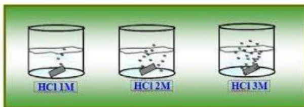
Gambar 2. Percobaan Pengaruh Konsentrasi terhadap Laju Reaksi (Sumber: ilmuusekolah.blogspot.com )
