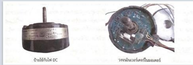
มอเตอร์พัดลมชุดคอยล์เย็น
