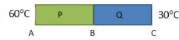
Bila panjang dan luas penampang kedua logam sama, tetapi konduktivitas logam P dua kali konduktivitas logam Q, maka suhu tepat pada sambungan di B adalah ...
