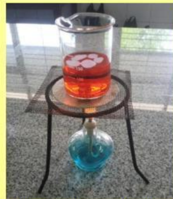
Gambar. 15 Rangkaian Alat Simulasi Konveksi Mantel Bumi
