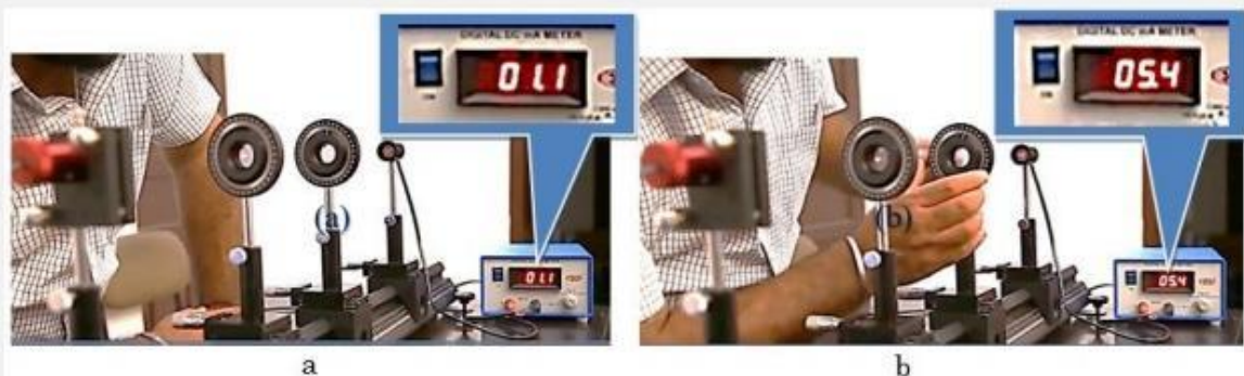
Gambar 1. Eksperimen Polarisasi Cahaya (a) Analisator Diputar 10^\circ dan (b) Analisator Diputar 20^\circ
