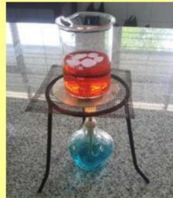
Gambar 2.51 Rangkaian Alat Simulasi Konveksi Mantel Bumi
