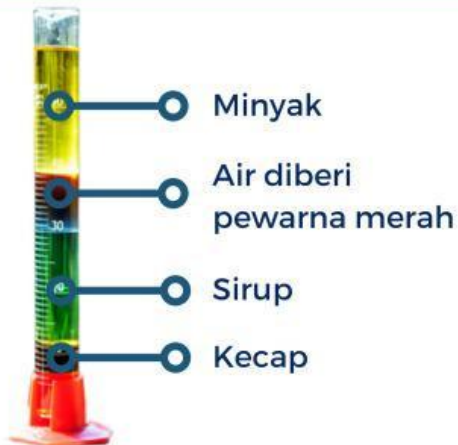
Gambar 8. Gelas ukur yang berisi massa jenis berbeda
