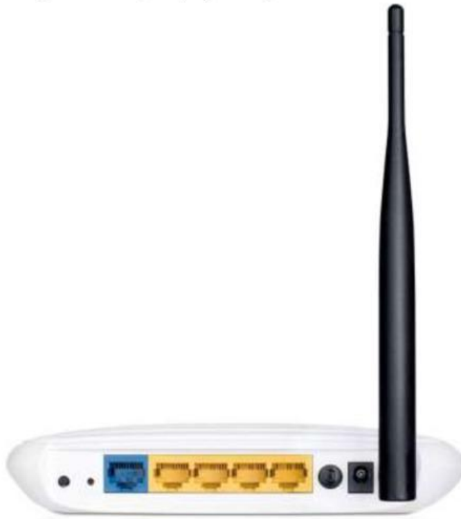
Рис.1 – Зовнішній вигляд портів роутера TP-LINK
