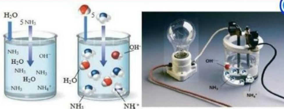
Gambar 25. Ionisasi larutan \text{NH}_3 dan daya hantar listrik larutan \text{NH}_3 (Sumber: Nivaldo, 2011)
