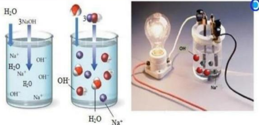
Gambar 24. Ionisasi larutan NaOH dan daya hantar listrik larutan NaOH (Sumber: Nivaldo, 2011)
