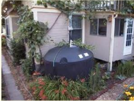
Gambar 5a. penggunaan sistem panen air hujan di sebuah rumah
