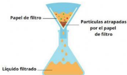
Imagen 1: Método de separación de mezclas: filtración
