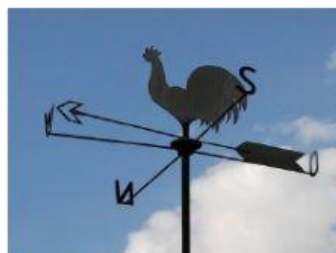
Veleta: determina la dirección de donde viene el viento.
