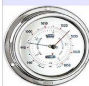
Barómetro: mide la presión atmosférica.
