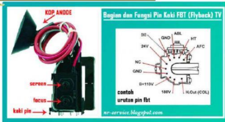
Gambar 4. Bagian Bagian dari Flyback
