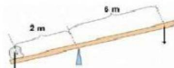
4.-Una carretilla de obra contiene una carga de arena de 60 kg. Calcula el valor de la fuerza que debes hacer para levantar la arena.
