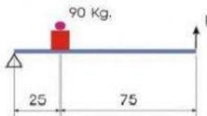
2.- Calcular el valor de la fuerza F que tenemos que aplicar en el extremo para levantar un peso de 90 Kgf. utilizando la palanca representada. Indica el grado de la palanca.
