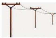
Kabel elektrik dan wayar telefon digantung secara kendur untuk membenarkan pengembangan dan pengecutan
