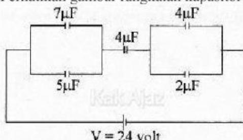
5 kapasitor tersusun seri dan paralel, besar energi listrik pada rangkaian tersebut Besar energi listrik pada kapasitor gabungan adalah ... ( $1 \mu\text{F} = 10^{-6} \text{ F}$ ).
