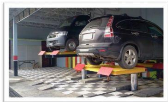
Sumber: Kemendikbud Gambar 1.12 Pompa Hidrolik Pengangkat Mobil
