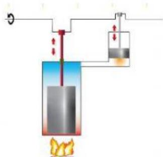
El rendimiento del motor de Stirling es superior al del motor de explosión y la máquina de vapor, sobre todo si se dispone de un regenerador con la función de absorber y ceder el calor en los diferentes ciclos del motor.
