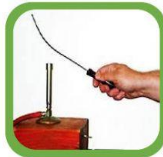
Gambar 4.4 Saat dipanaskan bimetal melengkung
