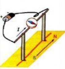
Repetimos el experimento, ahora conectando la batería de manera de que la corriente circule hacia el Sur.
