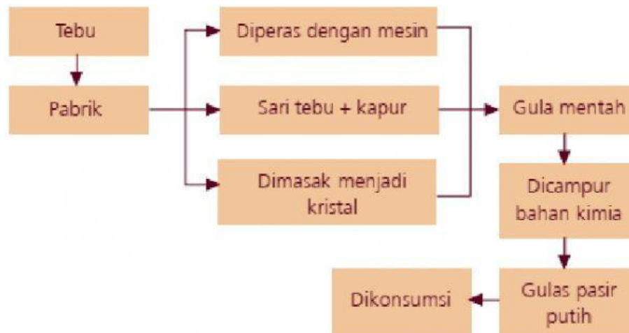
Gambar 9.3 Diagram proses pembuatan gula pasir
