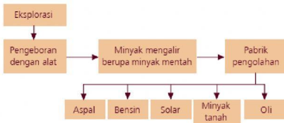
Gambar 9.4 Diagram penambangan minyak bumi
