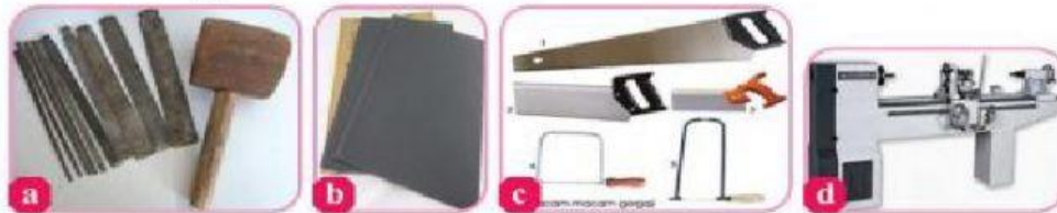
Gambar 1.4 Alat kerajinan kayu: a. pahat dan ganden b. amplas, c. aneka gergaji d. mesin bubut.
