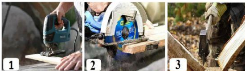
Gambar1.2. Alat potong: 1. Jigsaw, 2. Circle saw, 3. Kapak
