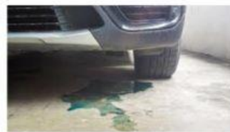
coolant leak - антифризов теч
