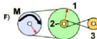
**2** Calcula la velocidad de giro de la polea conducida (1) del siguiente esquema; así como la relación de transmisión. Indica si se trata de un mecanismo multiplicador o reductor.
