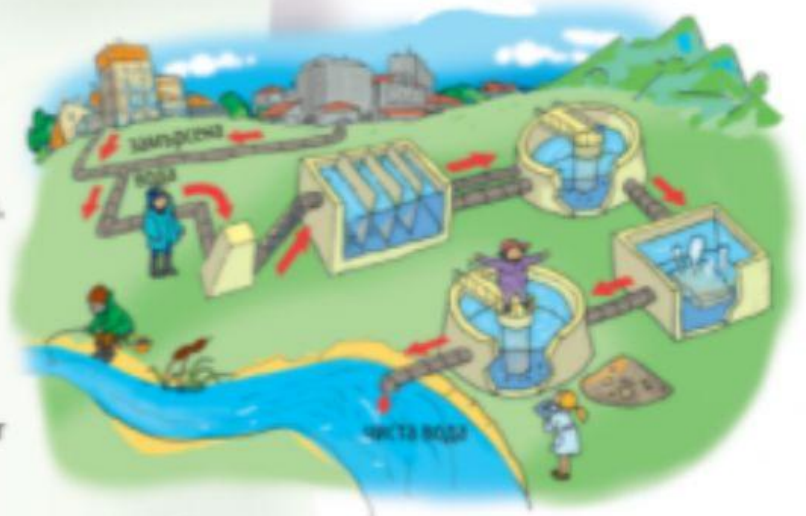
Пречиствателна станция за отпадъчни води
