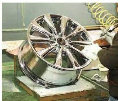
Krom memberi lapisan pelindung, sehingga besi yang dikrom akan menjadi mengkilap. Chromium plating dilakukan dengan proses elektrolisis. Krom dapat memberikan perlindungan meskipun lapisan krom tersebut ada yang rusak. Cara ini umumnya dilakukan pada kendaraan bermotor, misalnya bumper mobil.
