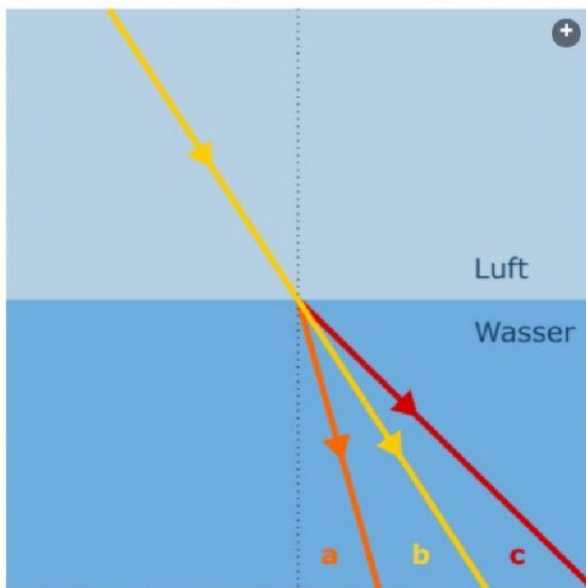
Welchen Verlauf nimmt der gelbe Lichtstrahl nach Durchgang durch die Grenzfläche? **Trage den korrekten Buchstaben ein.**
