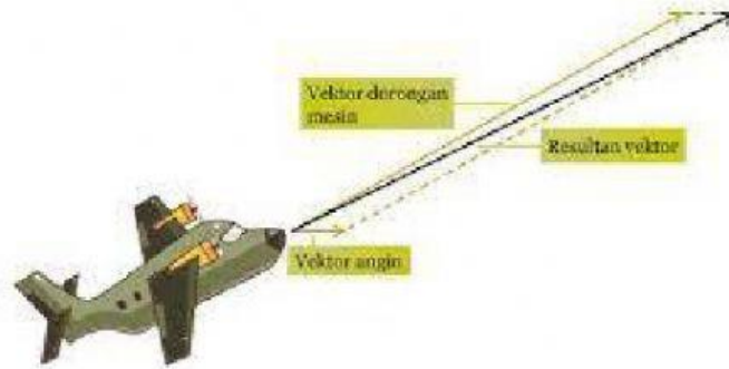
Gambar 1 : Pesawat terbang yang ingin terbang dan mendarat menggunakan metode vektor
