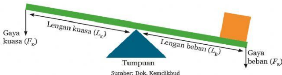
Sumber: Dok. Kemdikbud Gambar 2.8 Posisi Lengan Kuasa dan Lengan Beban
